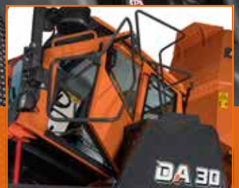
Barandillas de seguridad alrededor de toda la cabina
